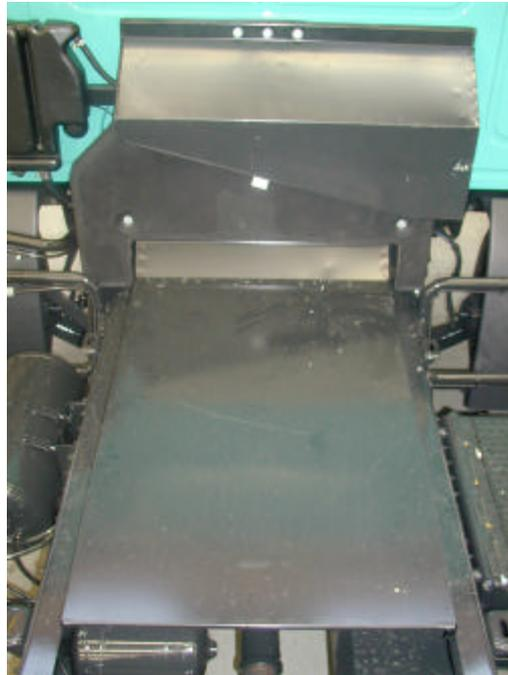
Bild 2: Abdeckung über dem Abgasrohr (Nur bei 6-Zylindermotoren)
