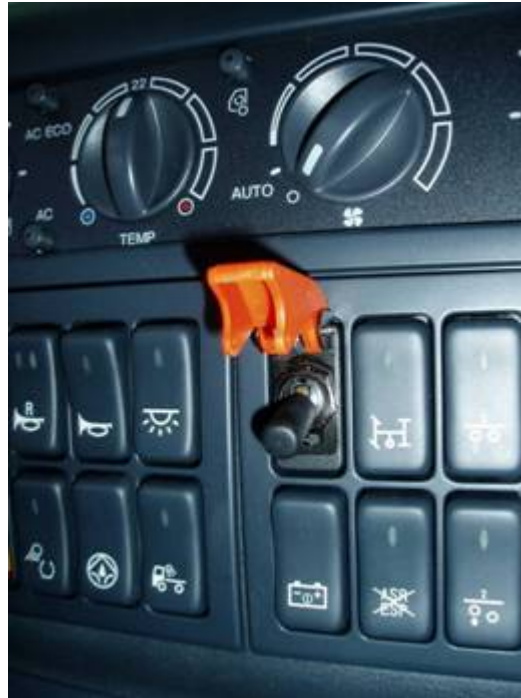
Abb. 1: Not-Aus-Kippschalter innen im Fahrerhaus / Emergency stop switch in the drivers cab
