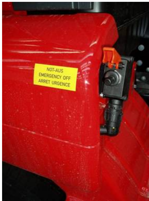
Abb. 2: Not-Aus-Kippschalter außen am Fahrerhaus / Emergency stop switch on the outside of the drivers cab
