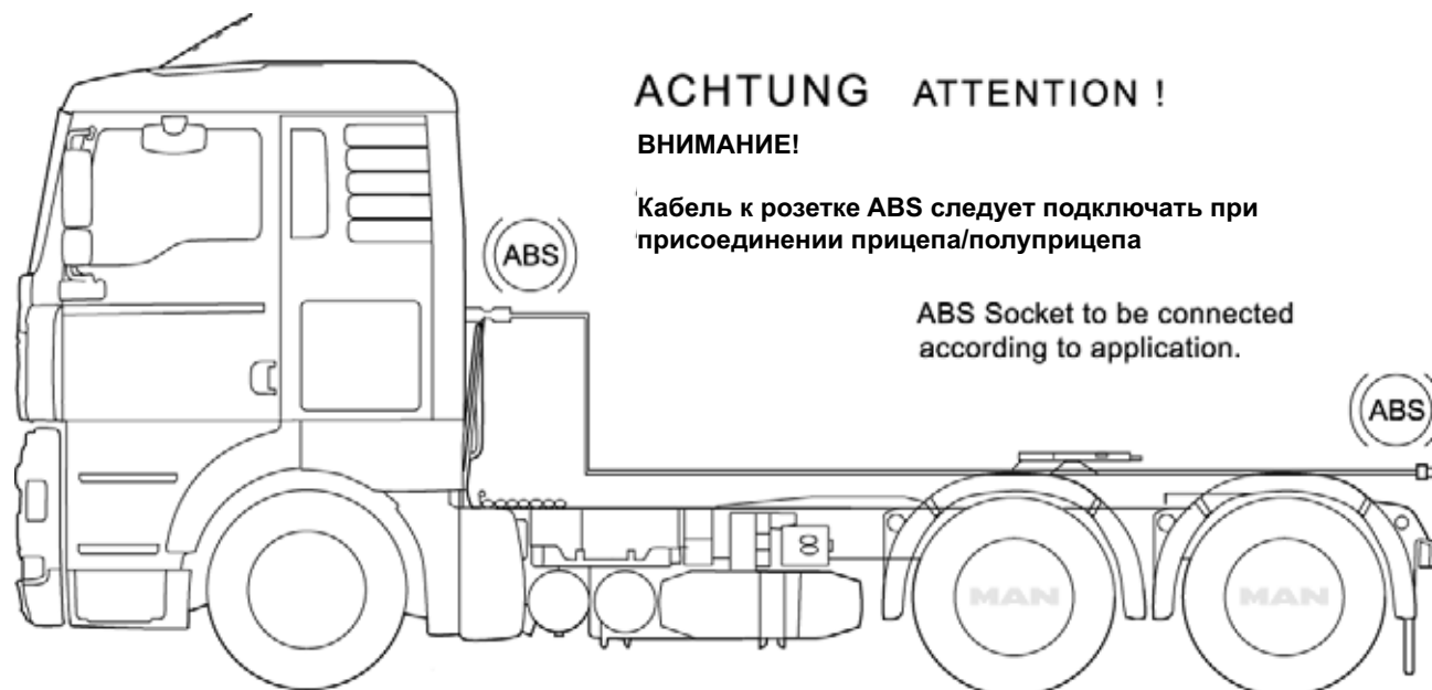
Рис. 3: Подключение соединительного кабеля ABS
