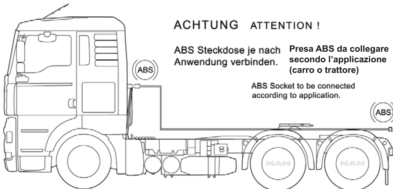
Figura 3: Utilizzo del cavo di prolunga ABS
